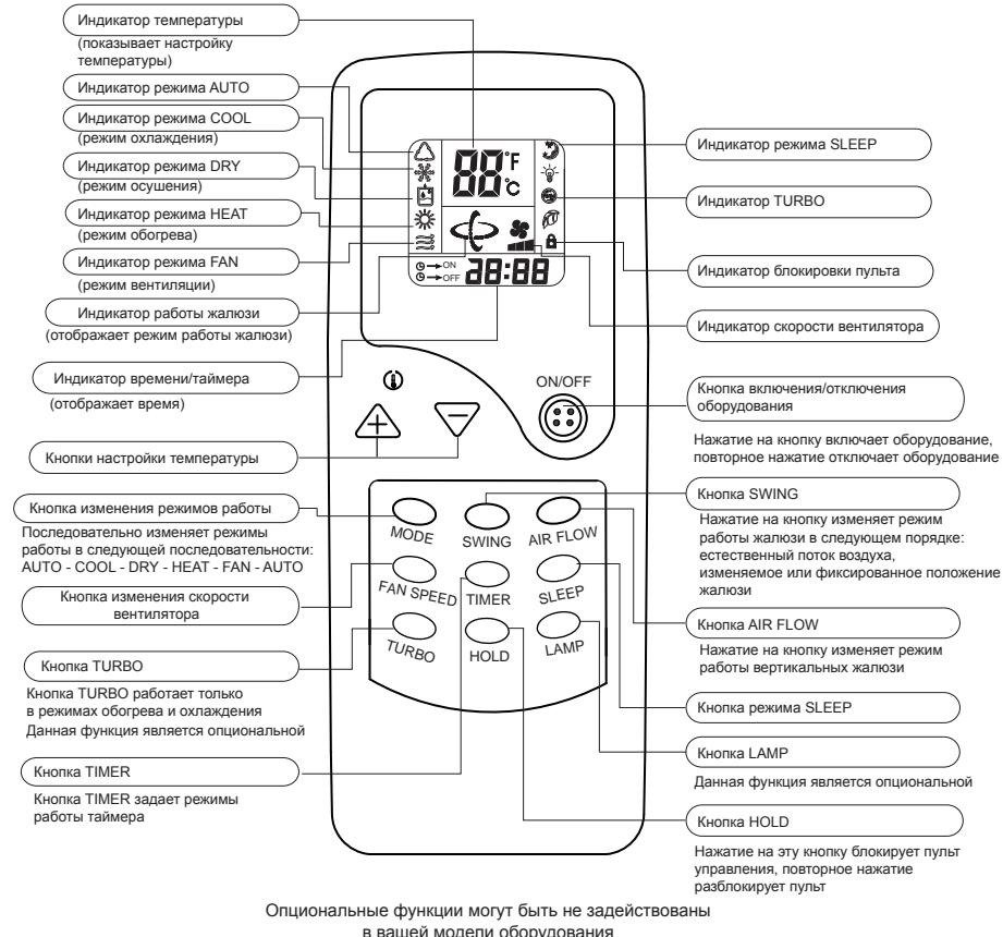
будет охлаждать помещение. Если температура ниже заданной, то блок будет работать в режиме вентиляции, т.е. будет работать только вентилятор внутреннего блока. Обратите внимание, что если задана скорость вращения вентилятора **AUTO** (автоматическая), то если температура в помещении будет ниже заданной, вентилятор будет работать на минимальной скорости вращения, пока температура в помещении не поднимется выше заданной, и не потребуется охлаждение.
